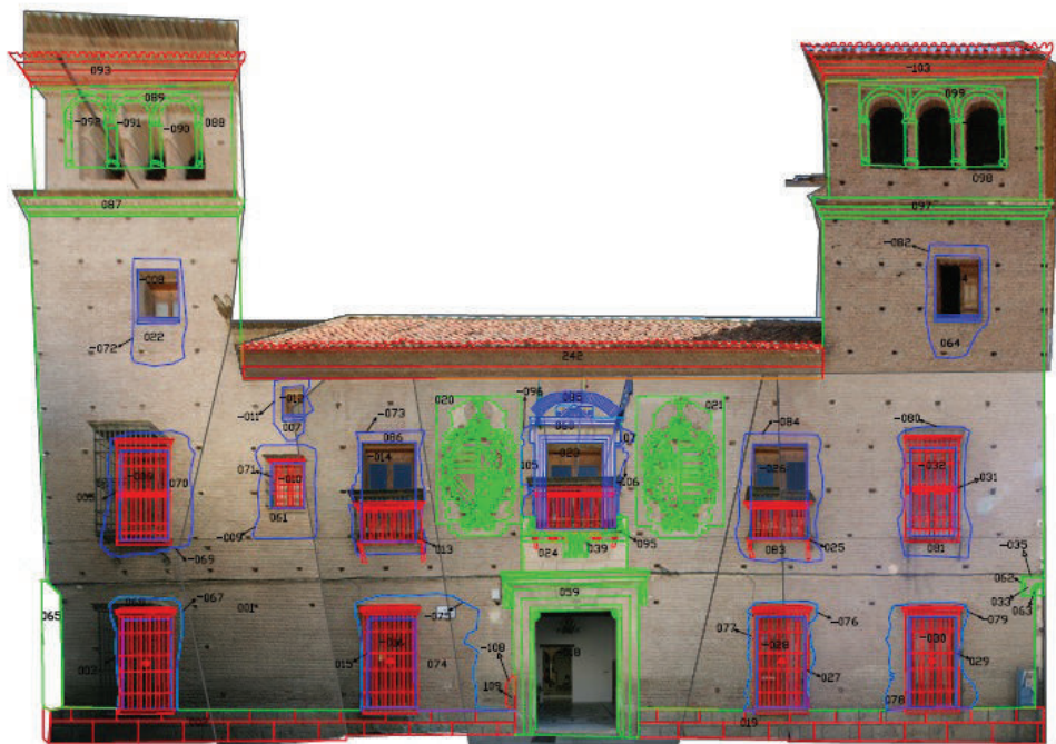
Fig. 11. Análisis estratigráfico de la fachada sur del palacio de Villaalegre. Fotografía y estratigrafía: Javier del Pozo.
